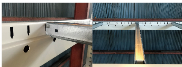
【デッキチャンネル】 パレット置き、ボードを敷く際のサポート
