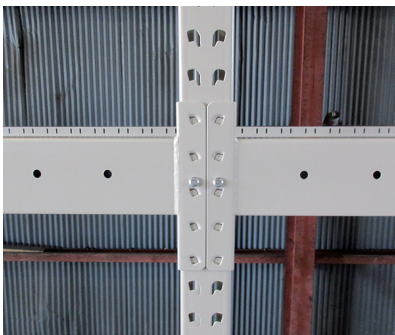
【ビーム取付部】 ボルトレスで 50mm ピッチで 段替え可能（ピンを差込）
